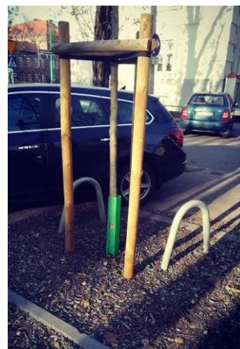
Ryc. 34. Zabezpieczenie drzewa za pomocą osłonki na pniu oraz ograniczników wjazdu.
