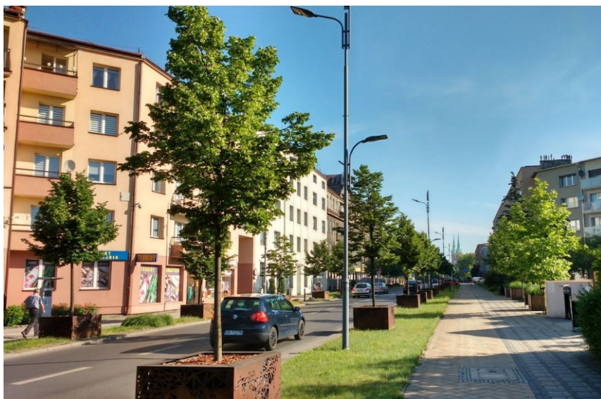
Ryc. 24. Nasadzenia lipy drobnolistnej w odmianie Rancho w donicach przy ul. Kościuszki w Rybniku. Rozwiązanie to pozwoliło na uniknięcie kolizji z sieciami. Źródło: materiały ZZM.
