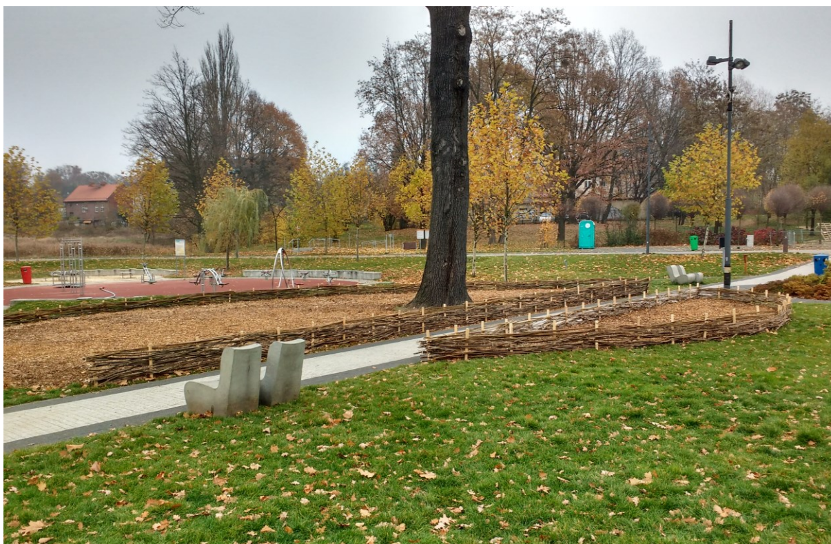
Ryc. 11. Parki im A. Fudalego, Zastosowanie naturalnych materiałów do wygrozdzenia terenu (zabezpieczenie przed kompresją gruntu wokół starego dębu). Źródło: Materiały ZZM
